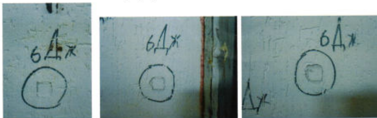
Рисунок 5 – Загальний вигляд дослідного зразка № 11-2/21 після випробування на ударну стійкість силою 6 Дж
