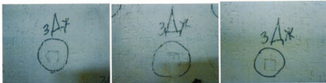
Рисунок 4 – Загальний вигляд дослідного зразка № 11-2/21 після випробування на ударну стійкість силою 3 Дж
