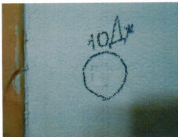
Рисунок 3 – Загальний вигляд дослідного зразка № 11-1/21 після випробування на ударну стійкість силою 10 Дж
